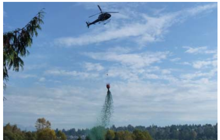
Photo : Utilisation d'un hélicoptère et d'un réservoir Bambi de 1 000 litres pour l'ensemencement hydraulique.
